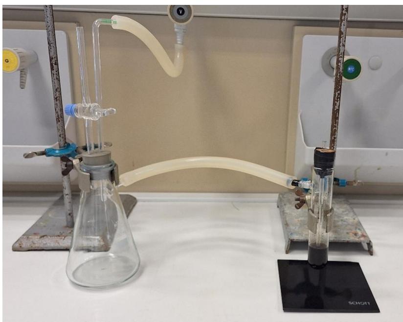
Slika 8.2. Aparatura za izvođenje sinteze kompleksa [\text{Co}(\text{NH}_3)_6](\text{NO}_3)_3
