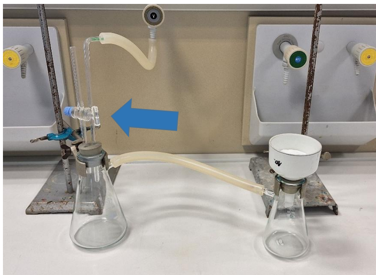
Slika 2. Sustav za filtriranje pod sniženim tlakom
