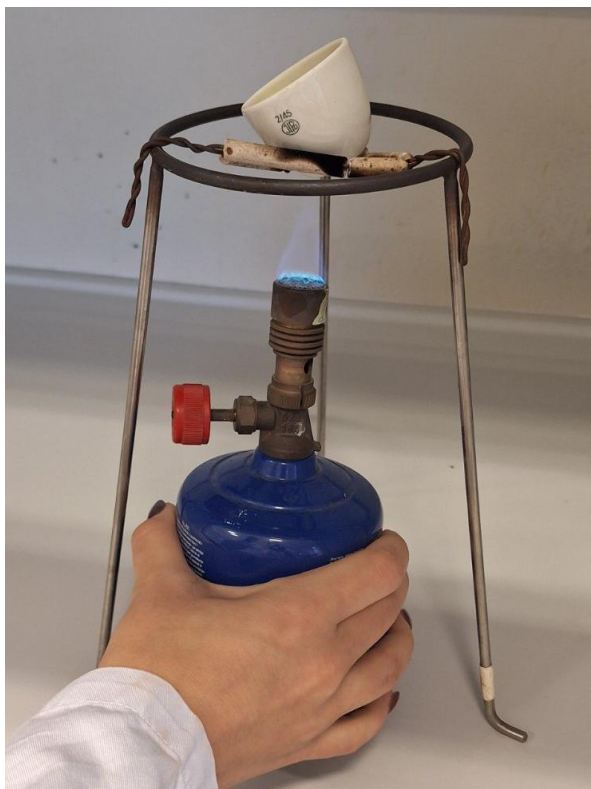
Slika 2.2. Aparatura za izvođenje sinteze \text{Cr}_2\text{O}_3
