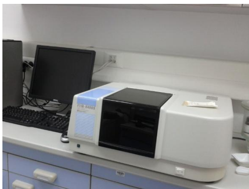
Slika 13.1. Spektrofotometar Shimadzu; FTIR 8400S
