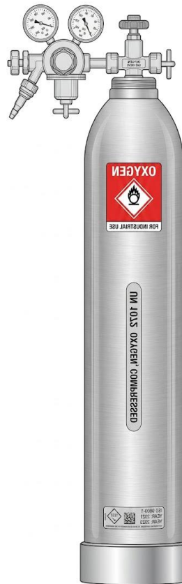
Slika 14. Redukcijski ventil na čeličnoj boci za plin
