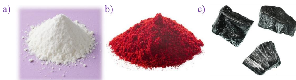
Slika 26. Slikoviti prikaz alotropskih modifikacija fosfora: a) bijeli, b) crveni i c) crni
