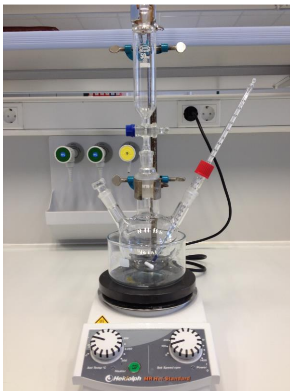
Slika 7. Aparatura za Grignardovu reakciju – Sinteza trifenilmetanola.
